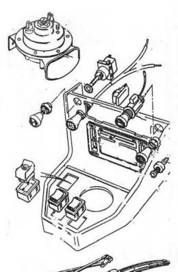
6A519916 Schalter Innenbeleuchtung 6AAHH7010 Zigarettenanzünderkit Schalter Choke 6A137607 Bremslichtschalter 6A134529 Türkontaktschalter MK2 6AYKC940Z
